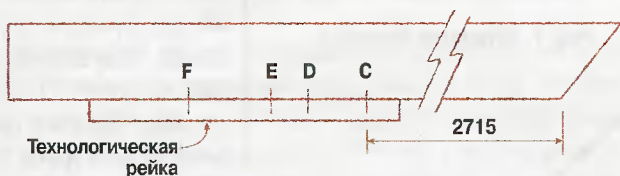
Рис. 3. Использование технологической рейки для переноса разметки с первого стропила.
